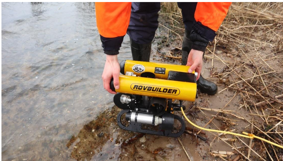
Figur 3-15 ROV, Fjernstyret undervandsfartøj (Remotely operated vehicle) benyttet til kortlægning af fjordens bund indenfor projektområde.
