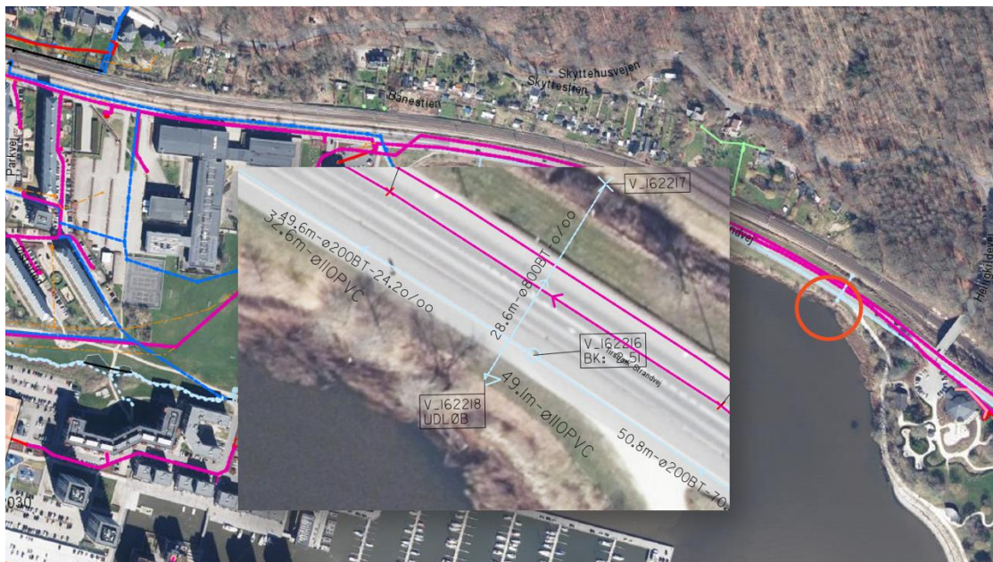
Figur 6-7 Udløb fra vejvand fra Tirsbæk Strandvej samt banegrøften. Dimension Ø800. (Kilde: webgraf – Vejle Spildevand).
