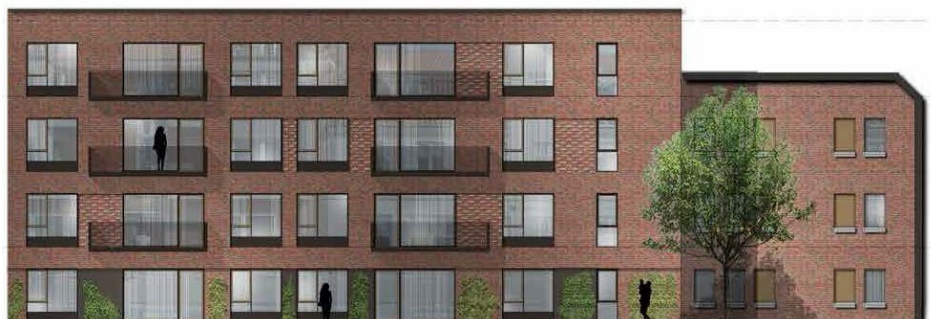
Figur 16: Illustreret facadetegning af ny bebyggelse i delområde 3 viser facader i røde tegl med mønstret murværk mellem flere af vinduerne. Mursten og facadeudformning er tilpasset den eksisterende bygning, der ses th. på illustrationen.
