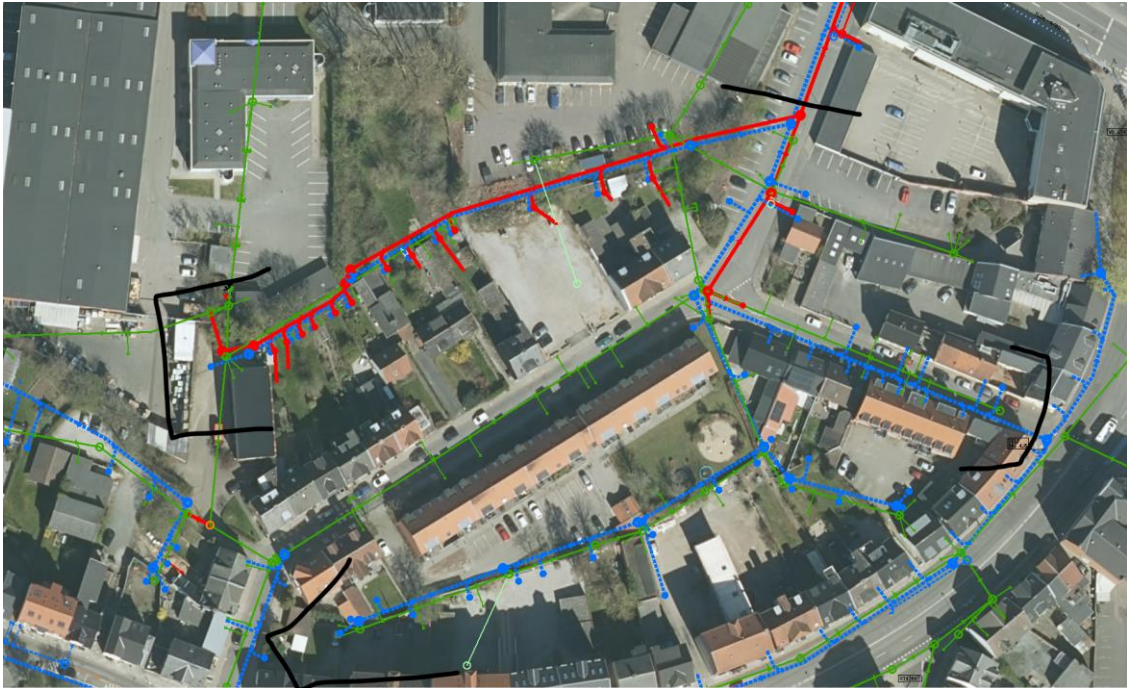
Figur 4. Grønne linjer viser eksisterende kloakledninger. Røde streger viser fremtidige spildevandsledninger. Blå streger viser fremtidige regnvandsledninger. Sorte linjer viser afgrænsning af etape 4B.
