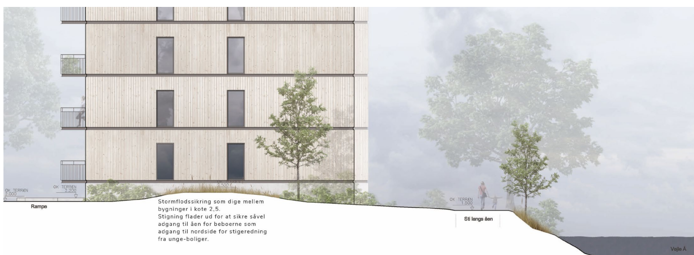
Figur 5: Illustreret snit af etageboligerne og Vejle Å. Snittet viser hvorledes stueetagen er hævet over nuværende terræn og at der mellem boligblokkene er et lille dige, der sikrer de bagvedliggende arealer ved forhøjet vandstand i åen. Illustration: RAVN
