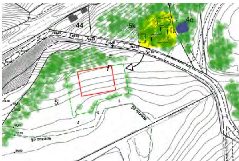
Figur 2 Bebyggelse markeret med gult nedrives. Rød firkant markerer byggefelt. Grøn stiple linje marker udbredelse af haveanlæg.
